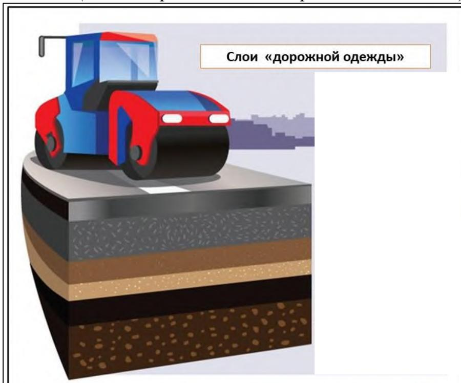
*Педагог:* Слои дорожной «одежды» служат для обеспечения безопасности движения и скоростного режима транспортных средств. Слои дорожной «одежды» состоят из земляного полотна, геотекстиля, песка, морозозащитного дренирующего слоя, фракционизированного заполнителя и асфальтобетона.
