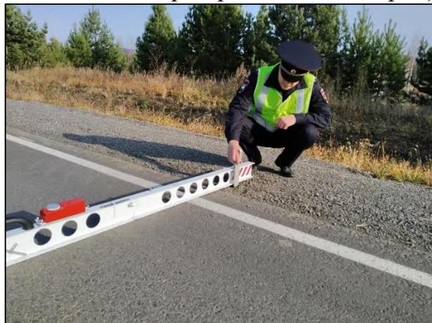
*Педагог:* основные технические средства, используемые в деятельности инспектора дорожного надзора: прибор для измерения коэффициента сцепления шин автомобиля с дорожным покрытием, прибор для измерения поперечных уклонов дорожного покрытия и откосов насыпи, прибор для измерения высоты инженерных сооружений и другие.
